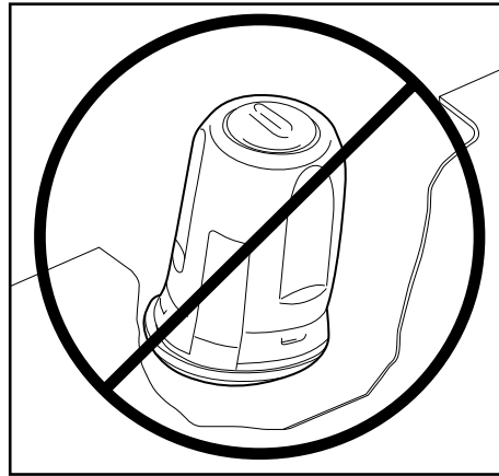
Fig 13. Felaktigt monterad gummigenomföring.
